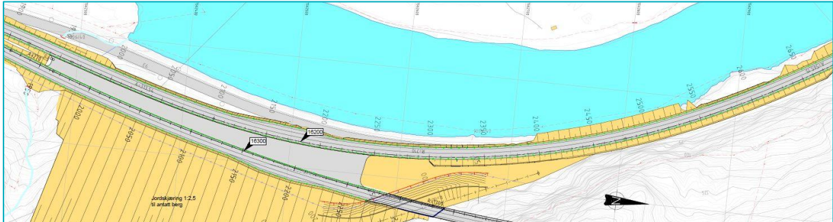
Figur 9 Utbedring av eksisterende E6 med veifylling ut i Gaula og behov for erosjonssikring.
